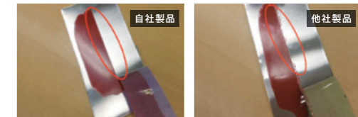
ペンキの侵入により、仕上がりが汚い。
